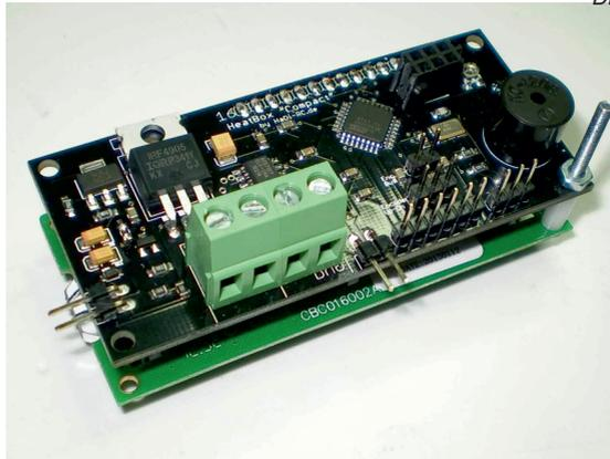
Für die Inbetriebnahme der "HeatBox compact24" sind lediglich die Stift-Buchsen-Leisten noch zu bestücken, die Box wird komplett betriebsbereit geliefert. Bei Montage als Sandwich direkt auf dem LCD-Modul erfolgt die Verbindung direkt über Stiflleiste am Display und Buchsenleiste an der HB c24.
